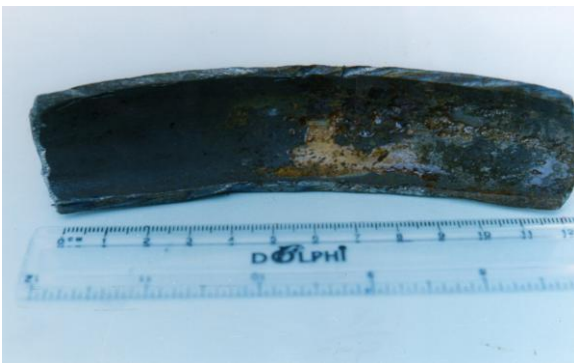
Fig. 4 Wall Thinning (Erosion)
